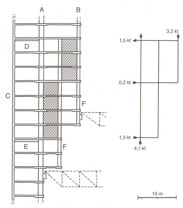
Fig. 2 Disposition des parois raidissantes aux étages 9 à 15
