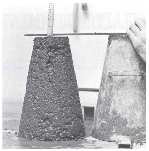
Fig. 1 Mesure d'affaissement (slump) d'un béton raide, pauvre en sable. On remarque la tendance au démélange et au manque de compacité, préjudiciable à la durabilité.
