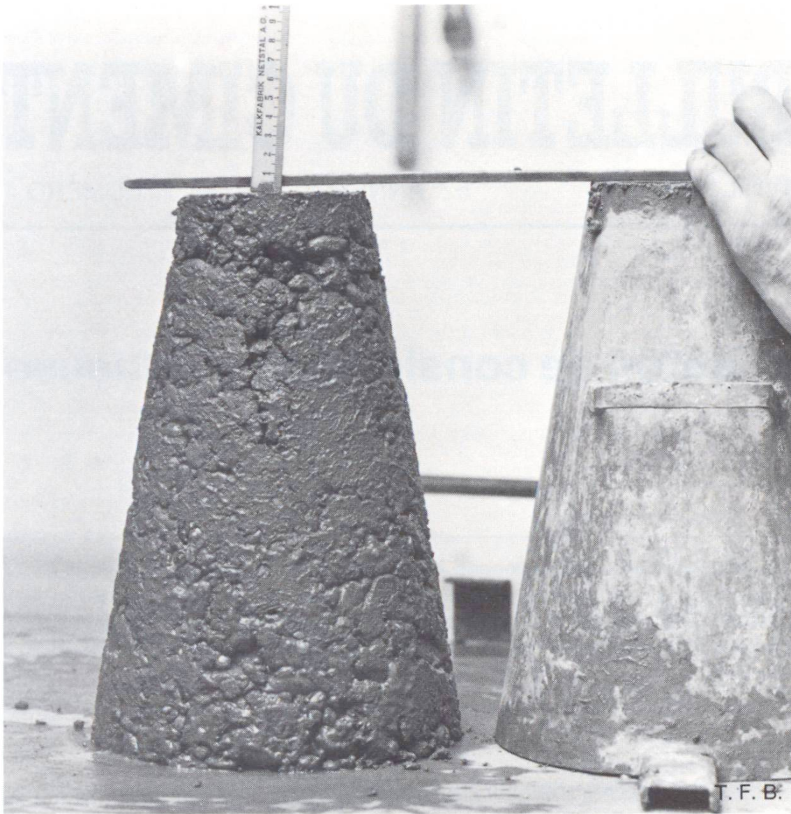
Fig. 1 Mesure d'affaissement (slump) d'un béton raide, pauvre en sable. On remarque la tendance au démélange et au manque de compacité, préjudiciable à la durabilité.
