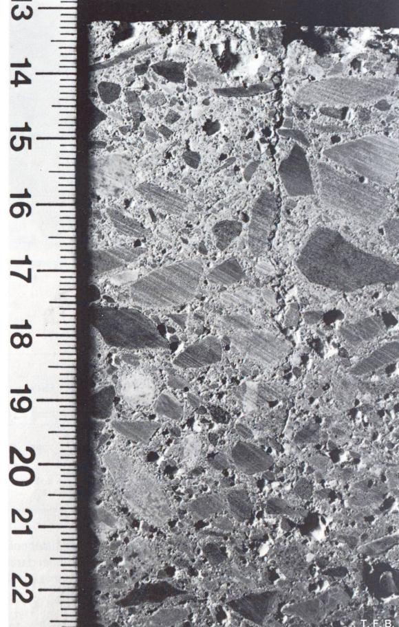
Fig. 4 Un cas dans lequel les causes des dégats par corrosion sont le manque de serrage du béton et des fissures précoces.
