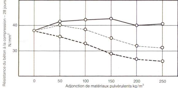
Fig. 1 Résistance à la compression d'un béton avec différents ajouts pulvérulents. Béton CP 300,
