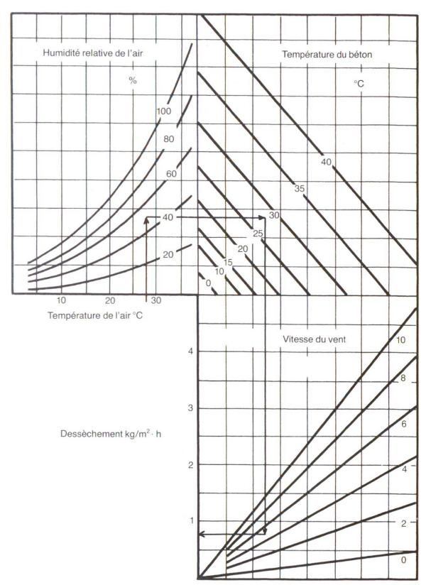
Fig. 1 Diagramme pour déterminer le dessèchement d'une surface de béton libre et horizontale (Bibliographie [1]). Exemple dessiné:
