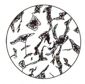
Fig. 1 Représentation schématique des pores de la pâte de ciment (diamètre du dessin env. 0.005 mm). A gauche: e/c 0.45, teneur en pores capillaires env. 10 %. Les vides ne sont reliés entre eux que par les pores du gel (en pointillé).
