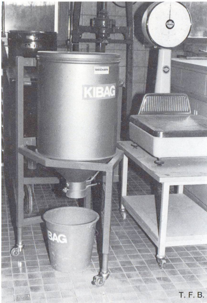
Silo de granulat pour laboratoire ainsi que balance
