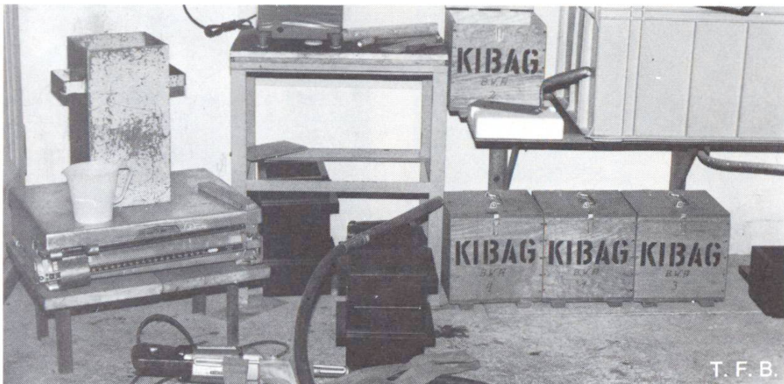
Coup d'œil dans le laboratoire d'une fabrique de béton: balance, récipient pour la mesure du degré de serrage, moules à éprouvettes, vibreur et caissettes de transport pour cubes d'essai
