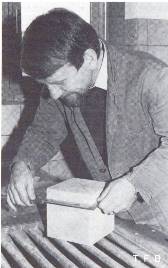
Mesure des dimensions d'un cube d'essai pour trouver son volume
