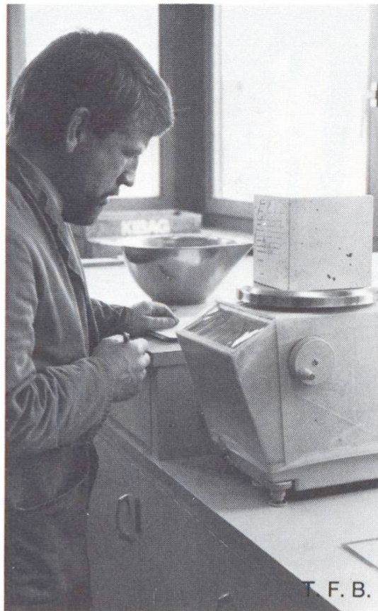
Détermination de la densité du béton durci
