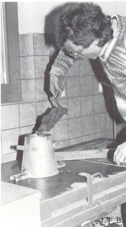
Mesure de l'étalement: remplissage du cône
