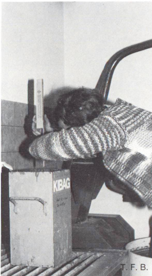
Degré de serrage: mesure de la diminution de hauteur
