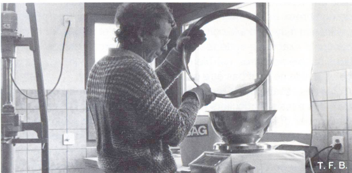
Pesage d'une fraction granulométrique
