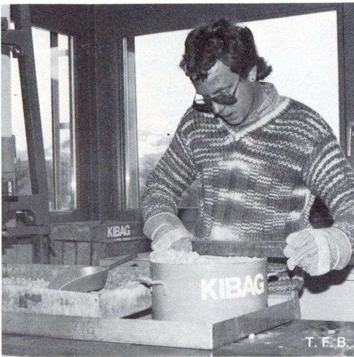
Détermination de la densité apparente du granulat
