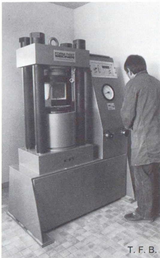
Essai de résistance à la compression sur cube
