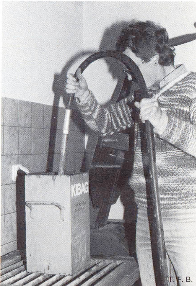
Degré de serrage: vibration de l'échantillon
