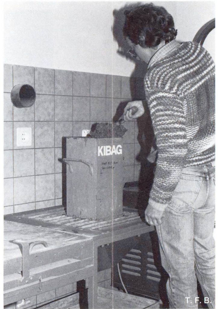
Degré de serrage: remplissage du récipient
