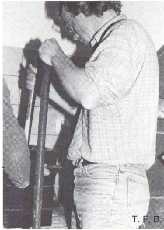
Serrage d'un cube d'essai
