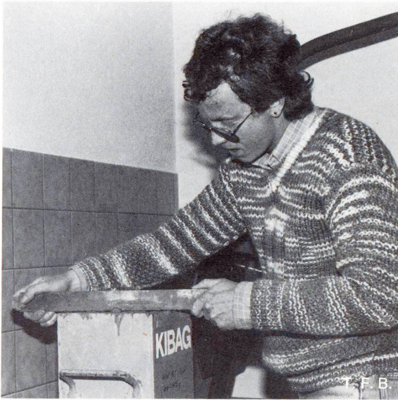
Degré de serrage: contrôle du remplissage du récipient
