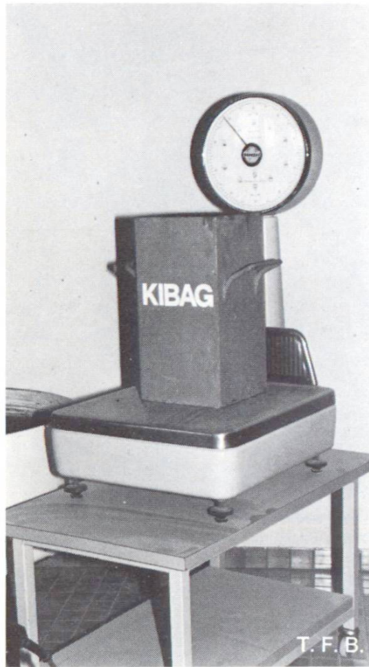
Détermination de la densité du béton frais
