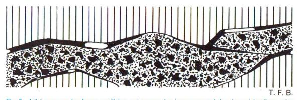
Fig. 5 Adhérence par les forces capillaires qui prennent naissance quand de minces interstices entre deux corps sont remplis d'eau ou de solution acqueuse.
