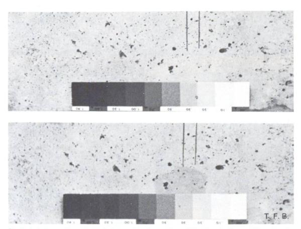
Fig. 4 La tache sombre au bas de la photo est due à un traitement à l'acide qui a dissous 1,8 mg de carbonate de chaux par cm².
