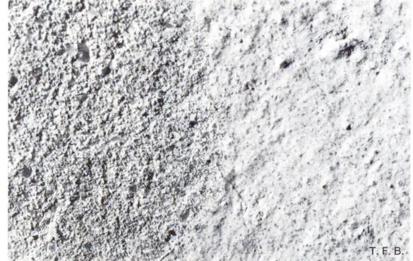
Fig. 5 Vue microscopique d'une surface traitée à l'acide comme à la figure 4. A la partie gauche de la photo, il manque environ 2 mg de CaCO³ par cm².
