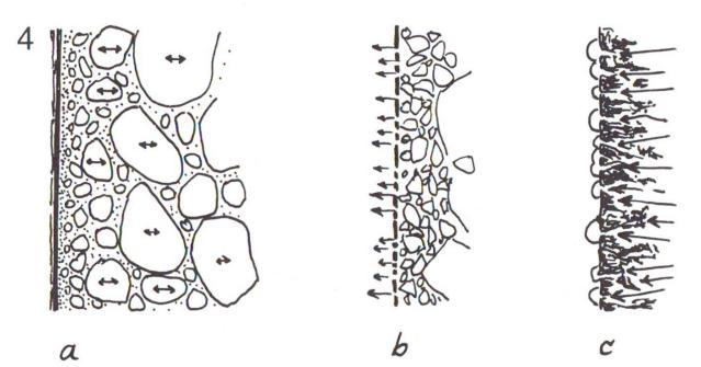
Fig. 2 a) Les gros grains oscillent moins que les petits sous l'action de la vibration. Il s'ensuit un enrichissement en eau et en ciment au voisinage de la surface dure et imperméable du coffrage.
