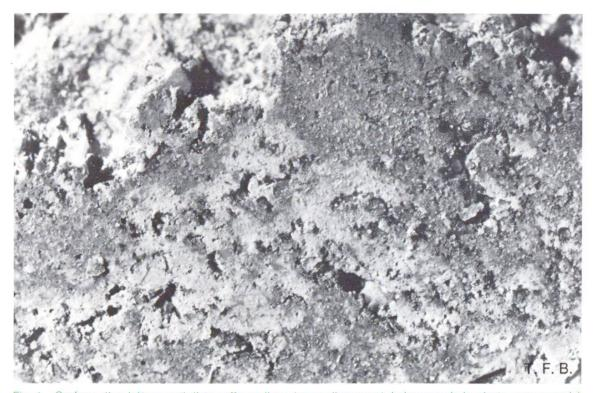
Fig. 1 Surface d'un béton sorti d'un coffrage lisse (agrandissement, la largeur de la photo correspond à 10 mm). On distingue des fragments de gel de ciment de teinte claire ou foncée, le clair ayant été provoqué par un enrichissement local en eau. Le gel légèrement vitreux laisse transparaître des grains foncés de ciment non hydraté. On remarque aussi des trous noirs et des efflorescences de chaux sous forme de points clairs qui contribuent à donner la teinte générale.
