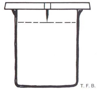
Fig. 2 Contrôle du remplissage constant du récipient au moyen d'une sonde dont la pointe a une position fixe par rapport au bord. Le niveau de remplissage peut être réglé exactement grâce à l'observation de la reflexion de la pointe dans l'eau. Le récipient doit être posé sur une surface horizontale.
