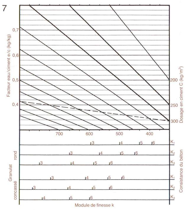
Fig. 3 Diagramme pour la détermination du dosage en ciment C. Données: Facteur e/c, module de finesse et consistance ( $K_1$  = faiblement plastique,  $K_2$  = plastique,  $K_3$  = molle), ainsi que la forme des grains (rond ou concassé). Dosages minima: 300 resp. 250 kg/m³ pour béton armé selon Norme SIA 162. La ligne traitillée donne les dosages minima en cas d'absence de farine 0 à 0,2 mm dans le granulat.
