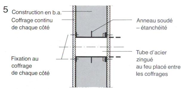
4. Passage d'un tube à travers une paroi
