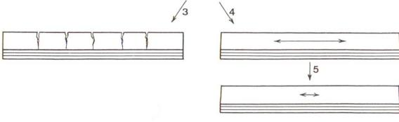
Fig. 1 Représentation schématique du déclenchement des fissures.
