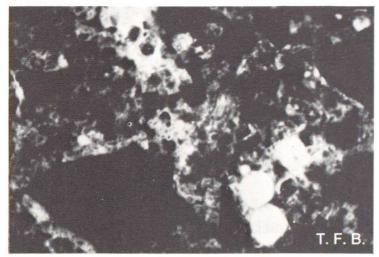
Fig. 4 Pores d'air de diamètres 1/50 à 1/10 mm dans une coupe mince de béton.
