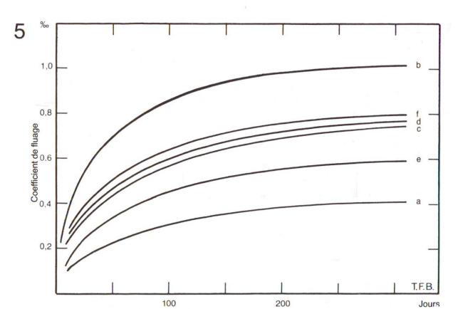
Fig. 2 Courbes de fluage typiques donnant le coefficient de fluage par rapport au temps. Béton 0 à 20 mm, CP 280 kg/m³, e/c = 0,6. Tension de compression 17,5 N/mm² = env. 35 % de la résistance à la compression. Chargement après 35 jours de conservation à l'humidité. Températures: a) 20, b) 70, c) 120, d) 145, e) 175 et f) 230 °C. Essais de Nasser et Marzouk, v. bibliographie.
