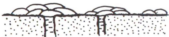
Fig. 5 Une température extérieure basse et/ou la chaleur dégagée par le béton frais favorisent l'expulsion de l'eau des capillaires et par conséquent les efflorescences de chaux. Si le processus dure assez longtemps, il peut se former à la surface un film continu de chaux de couleur blanche.
