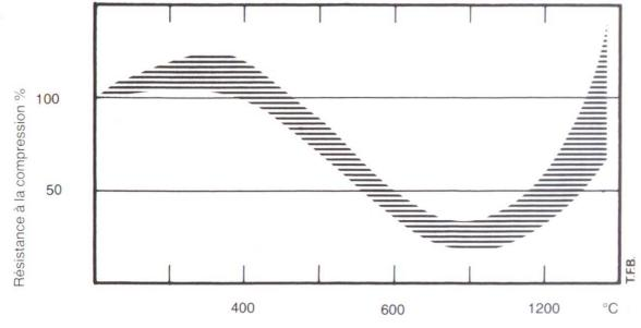
Fig. 2 Résistante relative à la compression de pâte de ciment refroidie après échauffement à la température considérée. Domaine des résultats de mesure de différents auteurs.
