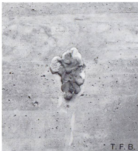
Fig. 9 La pâte est à moitié desséchée.
