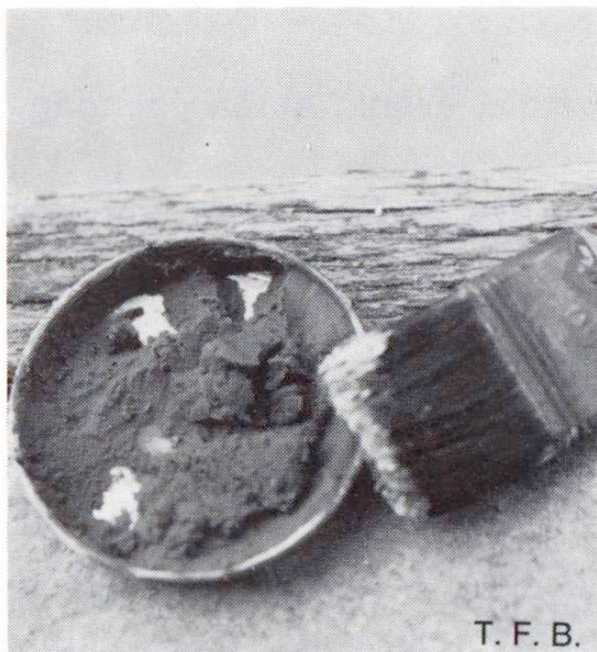
Fig. 3 Une pâte absorbante est préparée avec de la bentonite et du trichlorure d'éthane.
