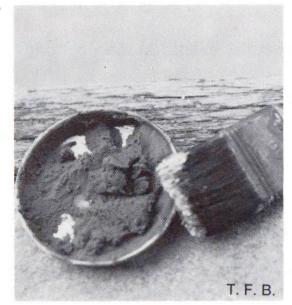
Fig. 3 Une pâte absorbante est préparée avec de la bentonite et du trichlorure d'éthane.
