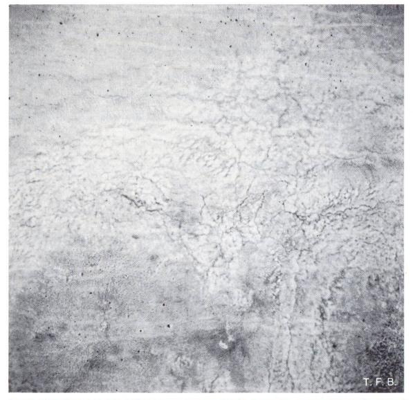
Fig. 1 Effet d'une huile de coffrage impropre, très fluide, de type A, sur un coffrage horizontal compact
