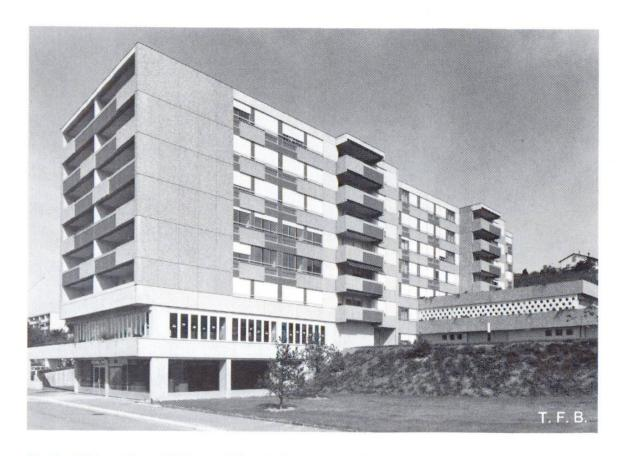
Fig. 7 Bâtiment locatif à Lutry. Béton lavé avec granulat de teinte foncée, combiné avec des dalles à coffrage en bois.
