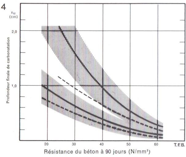
Fig. 1 Profondeur finale moyenne de carbonatation x<sub>u</sub>, en fonction de la résistance du béton. En haut: Béton en plein air sous abris. En bas: Béton en plein air non protégé. Hachuré: Domaine de dispersion de 84 % des cas. En traitillé: Valeurs moyennes mesurées après 7 ans. (Selon Schiessl)
