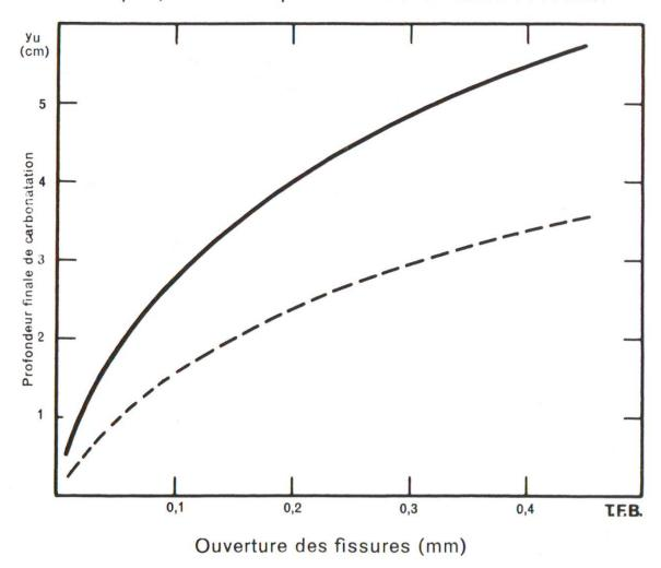
Fig. 3 Profondeur finale de carbonatation y<sub>u</sub> dans un béton fissuré, en fonction de l'ouverture des fissures. Valeurs calculées pour un béton de résistance 30 à 40 N/mm². Pour une résistance plus élevée, y<sub>u</sub> devient plus grand et augmente p. ex. de 0,6 cm quand la résistance passe à 60 N/mm². En traitillé: Valeurs de y<sub>u</sub> dans un béton dont les fissures sont fortement colmatées par des poussières et du carbonate. (Selon SchiessI)
