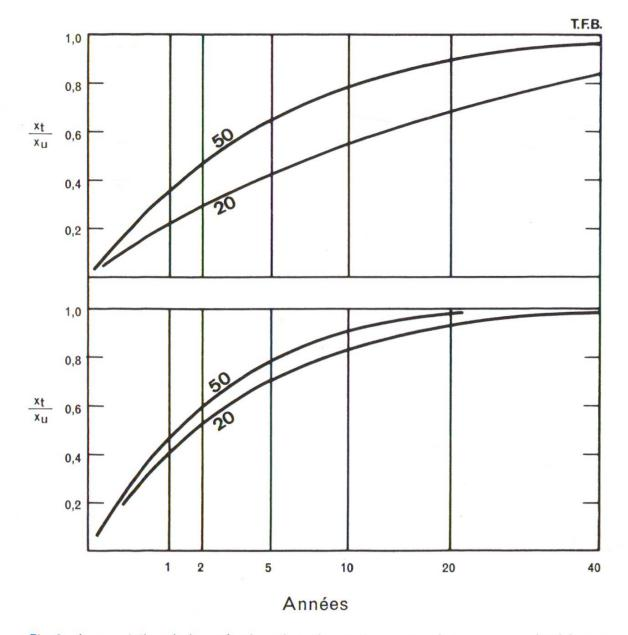
Fig. 2 Augmentation de la profondeur de carbonatation  $x_t$  avec le temps pour des bétons de résistance 20 et 50 N/mm².  $x_u$  = profondeur finale de carbonatation. En haut: Béton en plein air sous abris. En bas: Béton en plein air non protégé. (Selon Schiessl)
