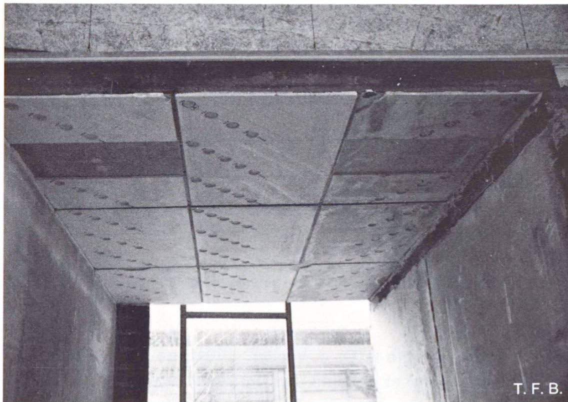
Fig. 14 Sur les surfaces d'essai sans produit d'accrochage, les enduits de plâtre se sont détachés d'eux-mêmes, après 3 mois pour celui de gauche et après 10 mois pour celui de droite. L'enduit du milieu n'est pas encore mort, mais il est bien malade!
