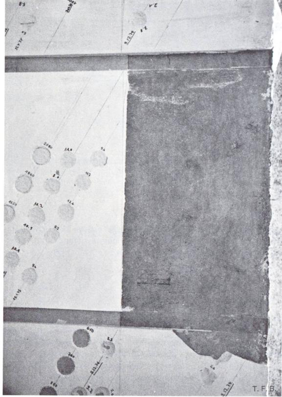
Fig. 15 La ligne horizontale de rupture de l'enduit coıncide exactement avec la limite de la surface du produit d'accrochage.
