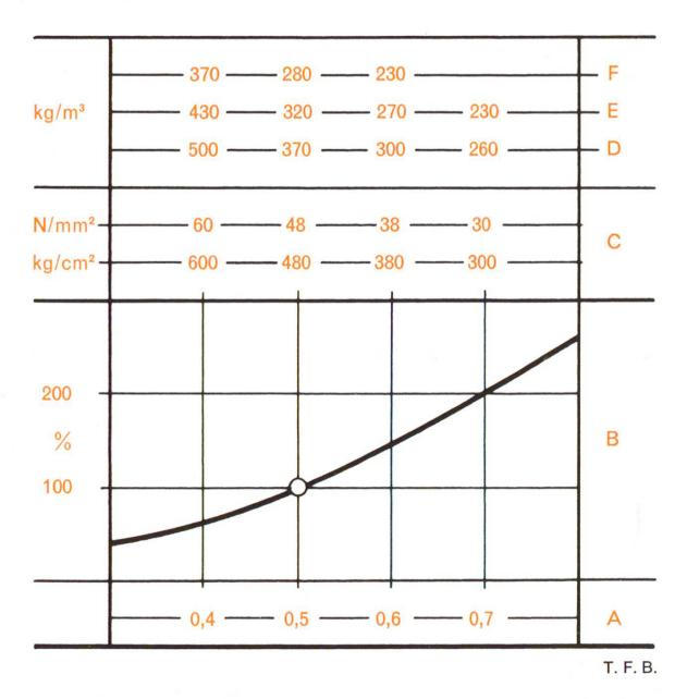
Fig. 3 Fluage final relatif (B) en fonction du facteur eau/ciment (A). La ligne C donne la résistance probable des bétons. Les lignes D, E et F donnent elles les dosages calculés des mêmes mélanges pour les consistances molle (D), plastique (E) et raide (F) (selon O. Wagner, voir bibliographie; calcul des mélanges par le calculateur de Rapp).
