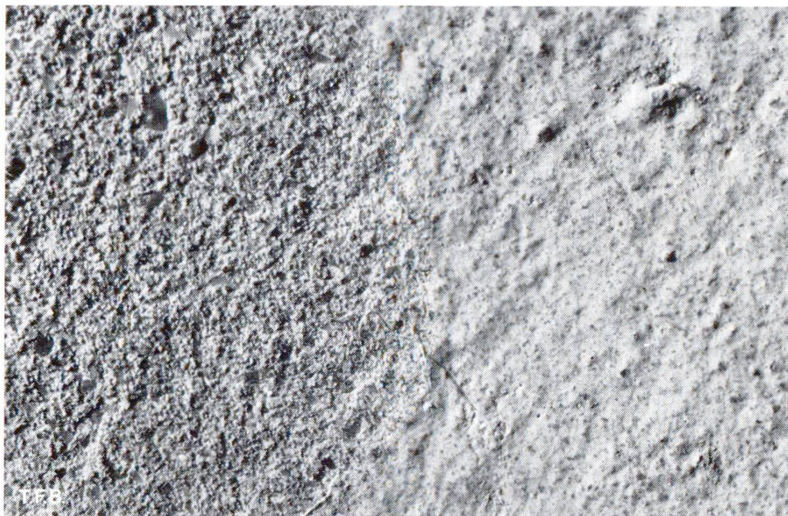
Fig. 1 Attaque de la chaux à la surface lisse d'un béton. Image agrandie. Largeur de la zone photographiée = 10 mm. A gauche, 2 mg/cm 2 de CaCO 3 ont été enlevés.
