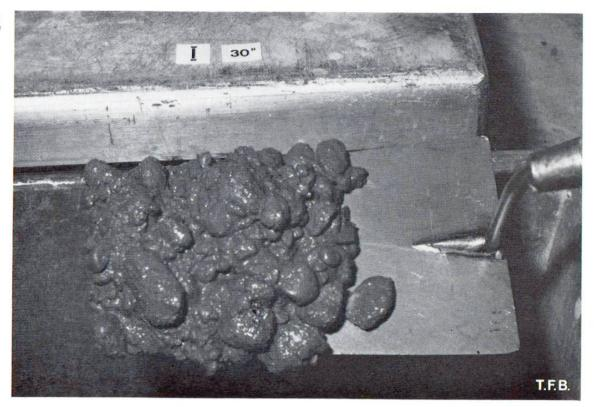
Fig. 2 Béton P 300, e/c 0.50 après 30 sec de malaxage. Les granulats ne sont pas complètement enrobés. Fort ressuage.
