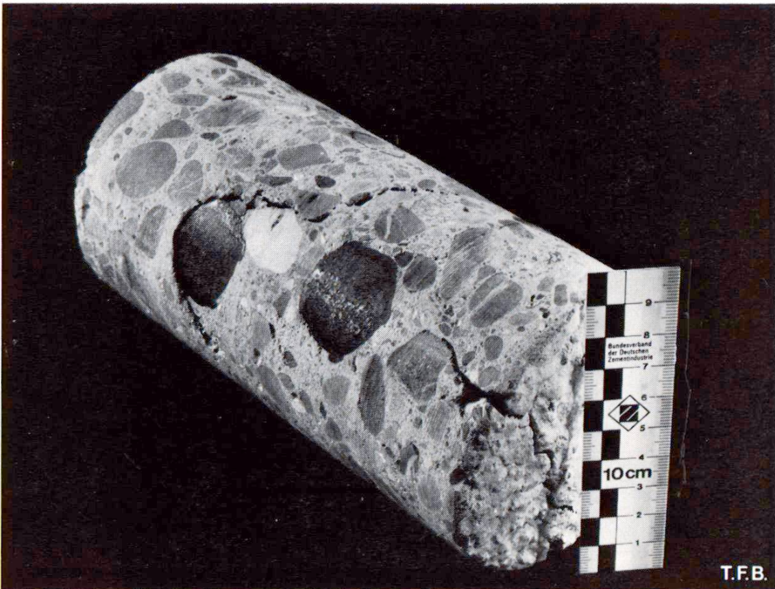
Fig. 3 Carotte de 90 mm montrant les fissures en profondeur. L'espace entre le béton et le dessous de la barre inférieure de l'armature permet de mesurer un affaissement de 2 à 3 mm.
