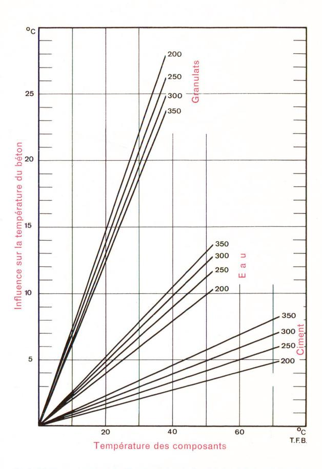
Fig. 2 Diagramme permettant de déterminer la température du béton frais à partir de celles des granulats, du ciment et de l'eau de gâchage, pour des dosages en ciment de 200, 250, 300 et 350 kg/m³. La somme des températures lues en ordonnée donne celle du béton frais.
