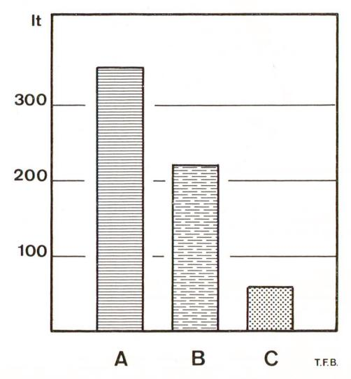
Fig. 2 Consommation d'énergie (en I mazout) pour un pilier de charge utile 1000 t, A: en acier, B: en terre cuite, C: en béton (selon Beijer).
