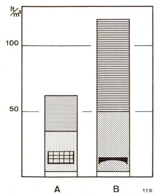
Fig. 1 Consommation moyenne d'énergie en litres de mazout par m³ de béton. A: bâtiments, B: ponts (hachuré: armatures, pointillé: béton, blanc: transports) (selon Beijer).
