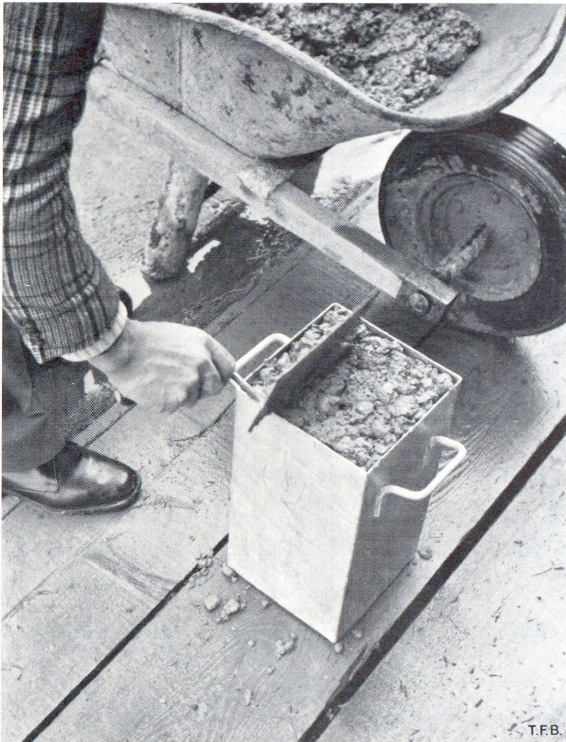
Fig. 6 Détermination du degré de serrage V. Le récipient de 200 \times 200 \times 400 mm est rempli de béton non tassé.
