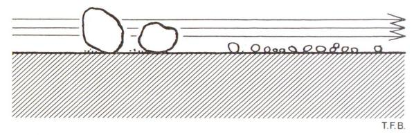
Fig. 3 Abrasion provoquée par le frottement des matériaux solides petits et gros charriés par l'eau.
