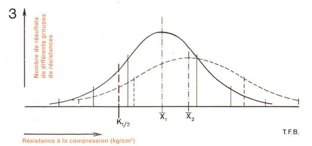
Fig. 3 Pour la même «valeur nominale» représentée par le point  $K_1/2$  (p. ex. 10% de résultats inférieurs à 270 kg/cm²), un béton ayant une grande dispersion des résistances (fig. 2) doit avoir une résistance moyenne plus élevée que celui dont les qualités ont une plus faible dispersion (fig. 1).
