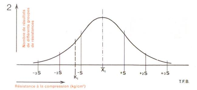
Fig. 1 La «courbe en cloche de Gauss» donne, en ordonnée, le nombre de résultats d'essais correspondant aux différents groupes de résistances reportés en abscisse (p. ex. groupe 280-290 kg/cm²). Il s'agit donc d'une représentation graphique de la répartition des résultats d'essais autour de leur valeur moyenne X<sub>1</sub>. L'écart-type S par rapport à cette moyenne se calcule par la formule:
