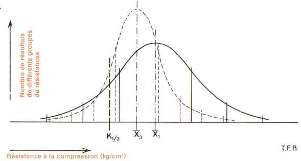
Fig. 5 De deux bétons ayant la même valeur nominale de la résistance  $(K_1/_3)$ , celui qui a un faible degré de dispersion de la résistance peut avoir une résistance moyenne  $(X_3)$  plus basse que celui dont la dispersion est plus grande  $(X_1)$ .
