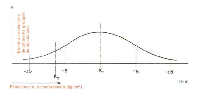
Fig. 2 Courbe de répartition des résultats d'essais d'un béton ayant une grande dispersion des résistances. Le seuil  $K_2$  (10% plus petits, 90% plus grands) est plus éloigné de la résistance moyenne  $X_2$  que dans la répartition de la figure 1.
