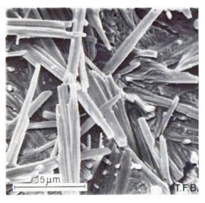
Fig. 3 Des aiguilles plus épaisses (bâtonnets) ont pu se développer facilement dans un pore. Il s'agit probablement d'une formation semblable à la tobermorite. Sur la paroi du pore, on voit une microfissure d'environ 0,5  $\mu m$ . La photo de droite montre un grossissement d'une partie de celle de gauche.
