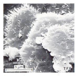
Fig. 2 Formation compacte de plaquettes intimement imbriquées, dont certaines ont exactement une section hexagonale (angles de 120° entre les arêtes). De minuscules aiguilles se sont développées en grand nombre, surtout sur les arêtes.
