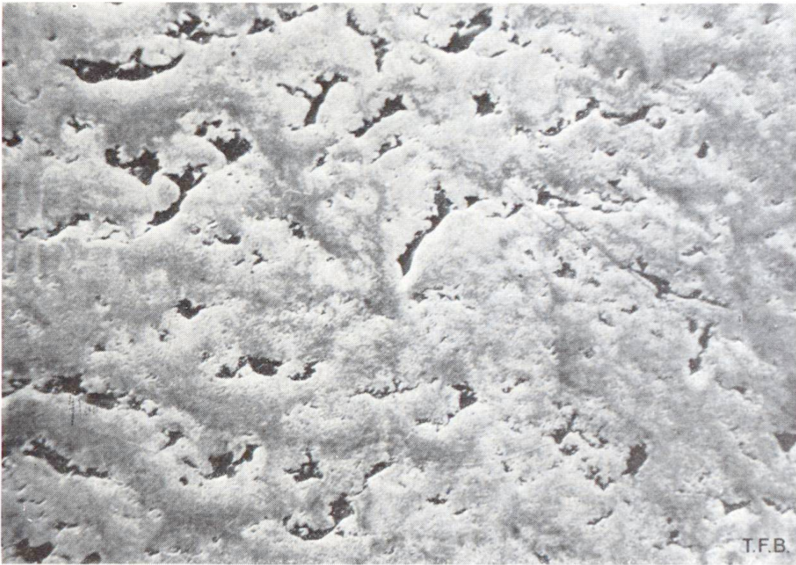
Fig. 4 Nid de gravier colmaté lors de la vibration. On remarque très bien les variations de teinte en forme de nuages clairs ou foncés (clair = davantage d'eau, foncé = davantage de ciment).
