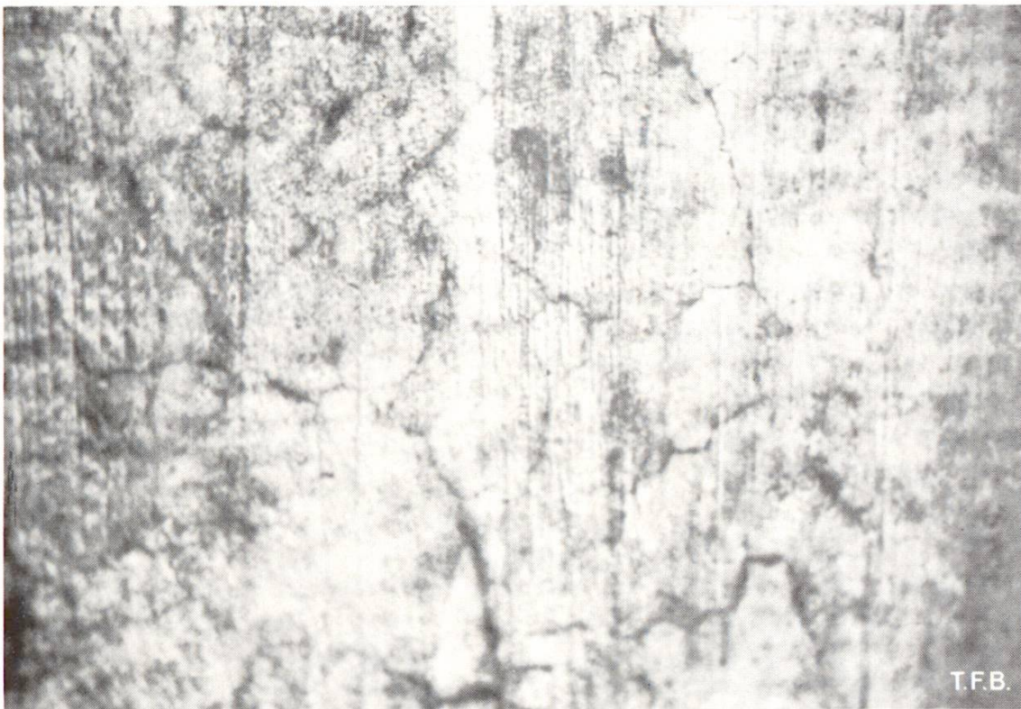
Fig. 1 Formation de fissures en réseau à la surface d'un béton à coffrage en panneaux imprégnés. Age 3 jours. Les fissures sont à peine visibles à l'oeil nu et ne se manifestent que par l'humidité qu'elles retiennent. Espacement des fissures 20–40 mm.
