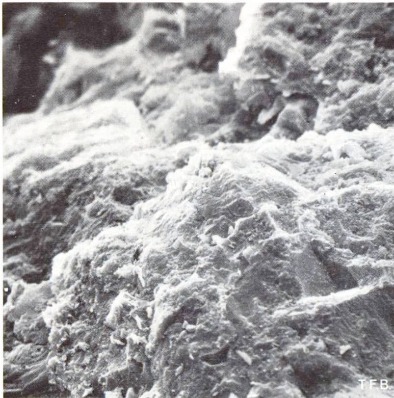
Fig. 4 Même échantillon que celui des photos 1 à 3 (surface de rupture d'une galette de ciment pur), mais photo prise au grossissement de 1100 sur une zone relativement compacte, sans pores, également aurifiée. On ne voit que quelques fragments de cristaux de Tobermorite. Les produits d'hydratation semblent former une masse compacte. Au milieu, quelques fissures de retrait dans cette masse; elles deviendront plus visibles sous grossissement supérieur.
