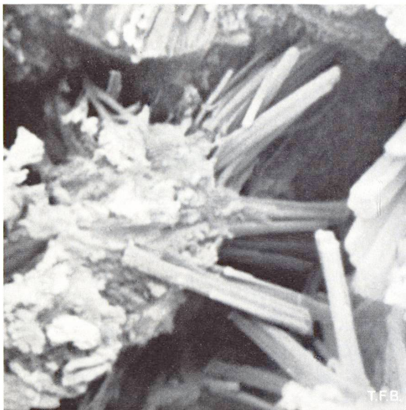
Fig. 3 Détail de la photo 2 au grossissement de 11 000. Au milieu à gauche, dans un pore, un grain de ciment, entouré d'une couche de points d'hydratation blancs sous formes cristallines. A partir de cette couche, les cristaux de Tobermorite croissent vers l'extérieur alors que d'autres aiguilles poussent à leur rencontre jusqu'à ce que le vide soit finalement rempli de cet amas feutré.
