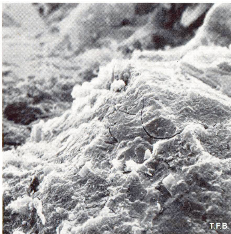
Fig. 5 Détail de la photo 4 au grossissement 2200. Le réseau de fissures de retrait est devenu plus visible.
