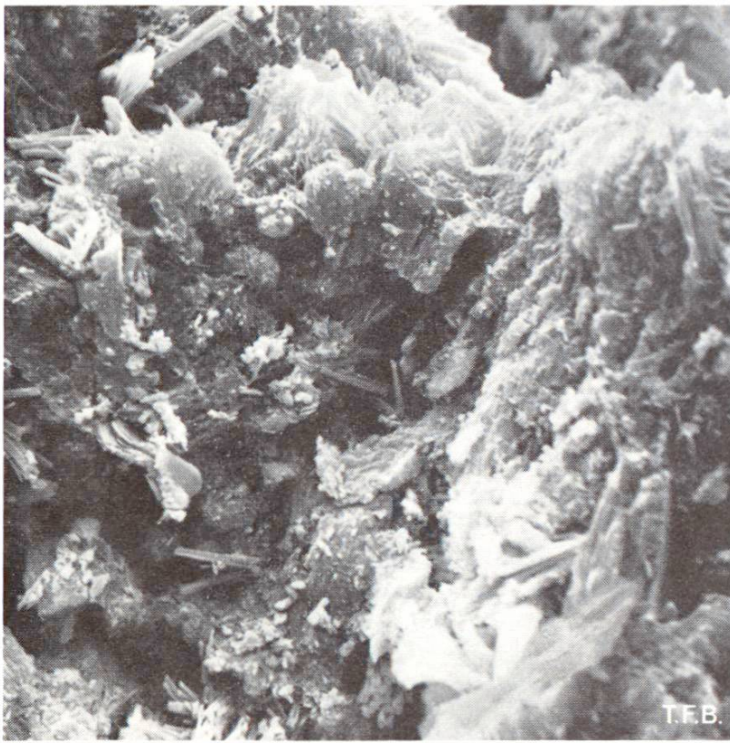
Fig. 1 Photo prise au microscope électronique à balayage. Surface de rupture d'une galette en pâte de ciment pur (galette pour l'examen de la stabilité de volume selon norme SIA, non séchée au four, âge 3 mois). Aurifiée sous vide. Grossissement environ 2500. La photo montre des vides ouverts, partiellement remplis d'un feutrage de cristaux qui doivent être de Tobermorite si l'on en juge pas analogie avec le silicate tricalcique pur, hydraté ( C_3S ).
