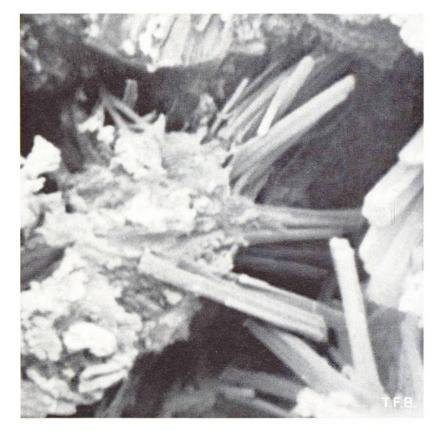
Fig. 3 Détail de la photo 2 au grossissement de 11 000. Au milieu à gauche, dans un pore, un grain de ciment, entouré d'une couche de points d'hydratation blancs sous formes cristallines. A partir de cette couche, les cristaux de Tobermorite croissent vers l'extérieur alors que d'autres aiguilles poussent à leur rencontre jusqu'à ce que le vide soit finallement complètement rempli de cet amas feutré.
