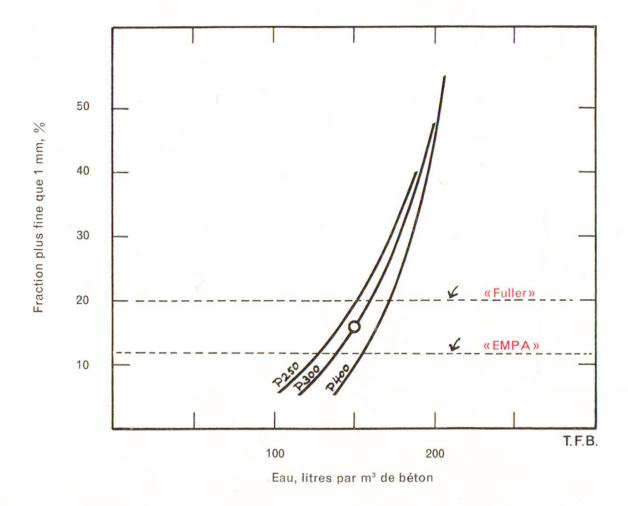
Fig. 3 Influence de a granulométrie sur le besoin en eau de bétons CP 250, 300 et 400 de gravier roulé 0-30 mm. Pour un béton CP 300, par exemple, si la granulométrie passe de la courbe EMPA à la courbe Fuller, le besoin en eau augmente de 20 I environ et le facteur eau: ciment augmente donc de 0,067 points. Ceci produit déjà une diminution de la résistance de 70 kg/cm² environ.
