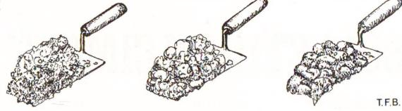
Fig. 1 Béton terre humide, faiblement plastique et plastique soumis à l'essai de la truelle
