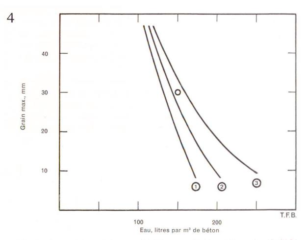
Fig. 4 Influence du grain maximum sur le besoin en eau des bétons. (1) terre humide, (2) faiblement plastique, (3) très plastique. Ce diagramme donne aussi les différentes teneurs en eau pour les différentes consistances.
