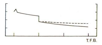
Fig. 3 Les variations effectives de longueur d'une poutre ou d'une colonne en béton de 10 m selon figure 2. Application d'une charge de 100 kg/cm² après un mois. La déformation totale après 3 mois est d'environ 9 mm =  $900 \cdot 10^{-6}$  (exemple pour montrer l'ordre de grandeur).
