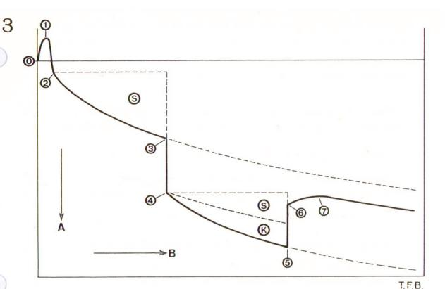
Fig. 2 Représentation schématique des allongements et raccourcissements du béton sous l'effet des différentes causes.
