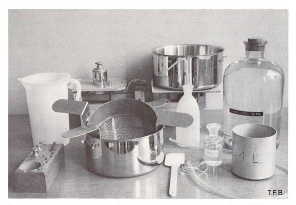
Fig. 1 Appareillage pour l'analyse du béton frais par la méthode « Canard » du LFEM se composant de: Balance avec série de poids, 2 marmites en acier de 22 et 24 cm de diamètre, 2 tamis de mailles 0,16 et 2 mm et de 20 et 19,5 cm de diamètre, tous deux avec poignées. 1 récipient de 1 litre, alcool industriel (1 à 1,5 l par analyse) à 10%, solution aqueuse de sucre de raisin, récipient de mesure de 2 l en plastic, pissette avec alcool, tuyau en caoutchouc avec pince-tube, spatule.
