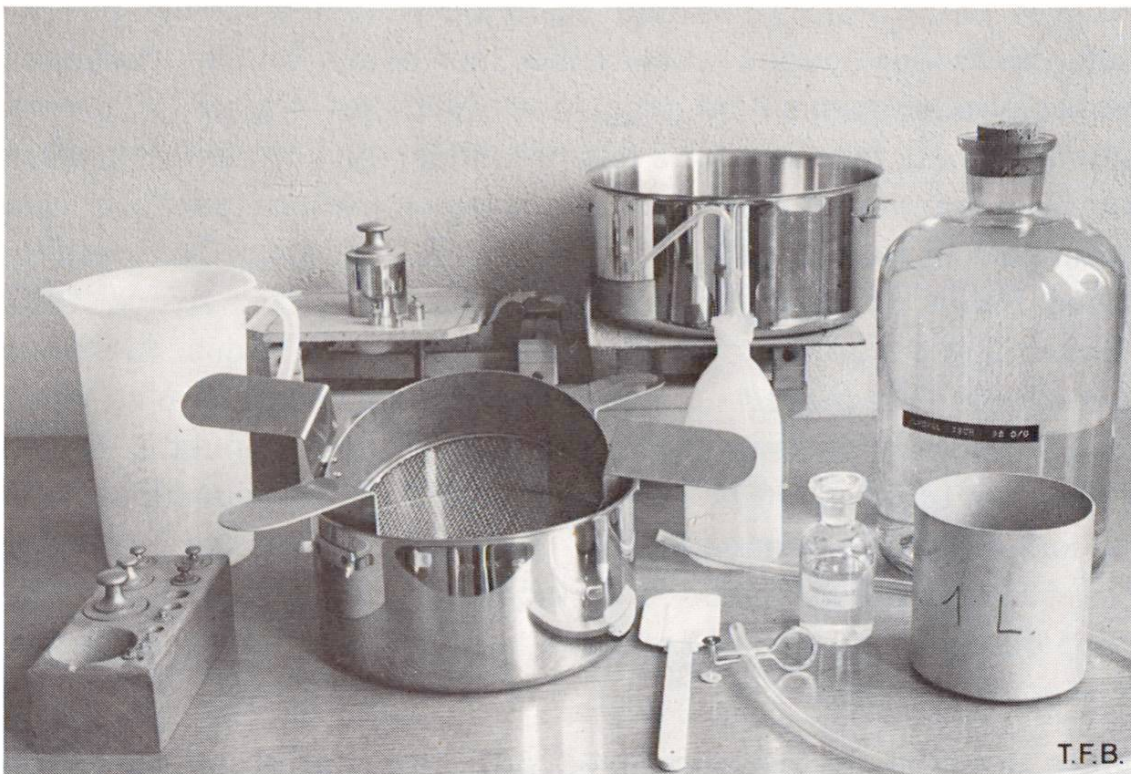
Fig. 1 Appareillage pour l'analyse du béton frais par la méthode « Canard » du LFEM se composant de: Balance avec série de poids, 2 marmites en acier de 22 et 24 cm de diamètre, 2 tamis de mailles 0,16 et 2 mm et de 20 et 19,5 cm de diamètre, tous deux avec poignées. 1 récipient de 1 litre, alcool industriel (1 à 1,5 l par analyse) à 10%, solution aqueuse de sucre de raisin, récipient de mesure de 2 l en plastic, pissette avec alcool, tuyau en caoutchouc avec pince-tube, spatule.
