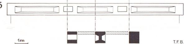
Fig. 4 Poutres préfabriquées en béton pour les planchers. Portée 13,8 m, écartement 3,5 m. La section est irrégulière à cause de deux grosses ouvertures destinées au passage des canaux de ventilation.
