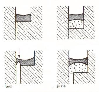
Fig. 3 Indications pour le jointoiement au mastic. Si le mastic colle sur le «sol» du joint, sa déformation sera entravée et il s'y produira des fissures en cas d'ouverture du joint. Avant le masticage, on introduira donc dans le joint un matériau inerte tel que mousse synthétique.
