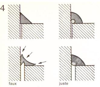
Fig. 4 Indications pour le jointoiement au mastic. L'application préalable d'un matériau inerte est aussi nécessaire dans les joints d'angle; à défaut de cela, des fissures se produiront dans le mastic lors de l'ouverture du joint.
