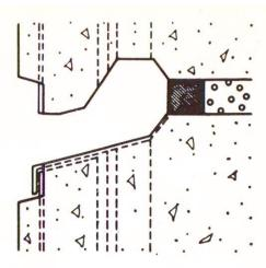
Fig. 6 Joint à double étanchéité. A gauche joint vertical (étanchéité à l'eau de pluie au moyen d'un profilé élastique). A droite joint horizontal. Etanchéité au vent dans les deux cas au moyen d'un mastic.
