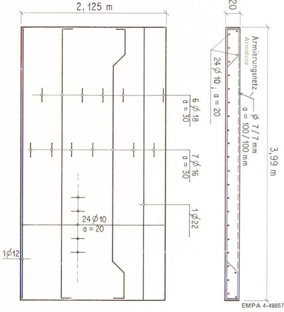
Fig. 3 Coffrage et armature des dalles.
