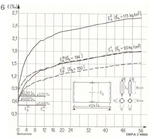
Fig. 5 Courbe des déformations par compression  $\mathcal{E}_b$  et  $\mathcal{E}_s$  en fonction du temps, pour les dalles II et III (en pointillé) et pour les prismes (en trait plein). Temps en semaines.  $\mathcal{E}_b$ : Déformation par compressoin de la fibre supérieure au milieu de la portée.  $\mathcal{E}_s$ : Déformation par compression des prismes chargés axialement.
