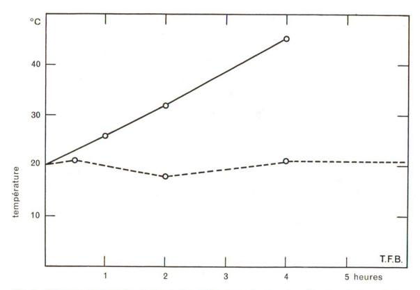
Fig. 2 Influence de la durée d'attente d'un béton frais de ciment portland sur la température du mélange (d'après Wischers).
