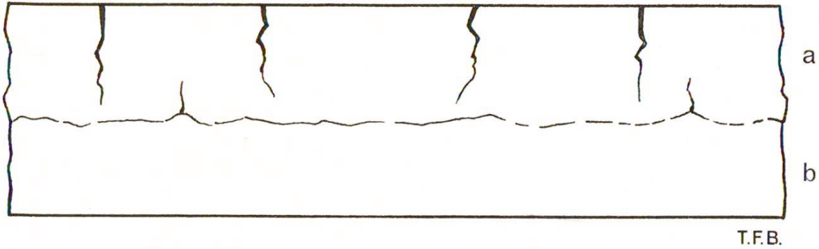
Fig. 2 Fissuration provoquée par la différence de retrait entre des bétons jeune (a) et vieux (b).
