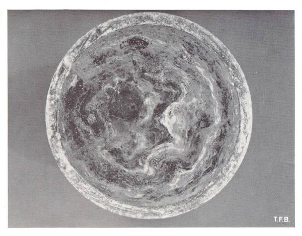
Fig. 1 Concrétions de chaux dans le tuyau de descente d'un grand toit plat. Les dépôts ont provoqué une obturation totale de la conduite.
