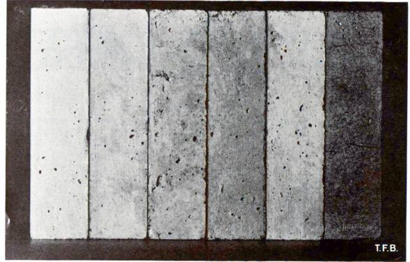
Fig. 1 Divers tons de gris d'un béton provoquées par des différences dans les conditions de conservation. (Les éprouvettes ont toutes été préparées de la même façon et ont exactement la même composition).
