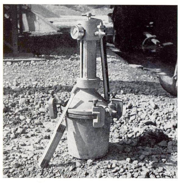
Fig. 1 Appareil pour la mesure de la teneur en air du béton frais. On place dans le récipient une quantité connue de béton qu'on recouvre ensuite d'eau. Lors de la mise sous pression du tout au moyen d'une pompe à main, le volume diminue plus ou moins suivant la quantité d'air contenue.
