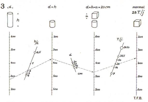
Fig. 1 Abaque permettant d'évaluer la valeur normalisée de la résistance à la compression sur cube à 28 jours à partir de mesures faites sur carottes prélevées dans l'ouvrage. Dans l'exemple reporté, les valeurs données sont: Résistance mesurée, 280 kg/cm² sur carotte h – 20 cm et d = 10 cm d'un béton âgé de 20 jours.
