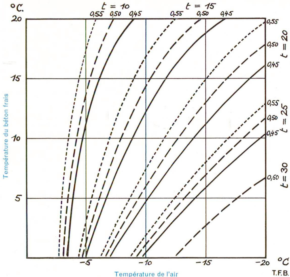
Fig. 3 Ce diagramme permet de répondre à la question de savoir si le béton atteindra la résistance critique avant ou après s'être refroidi jusqu'à zéro degré.
