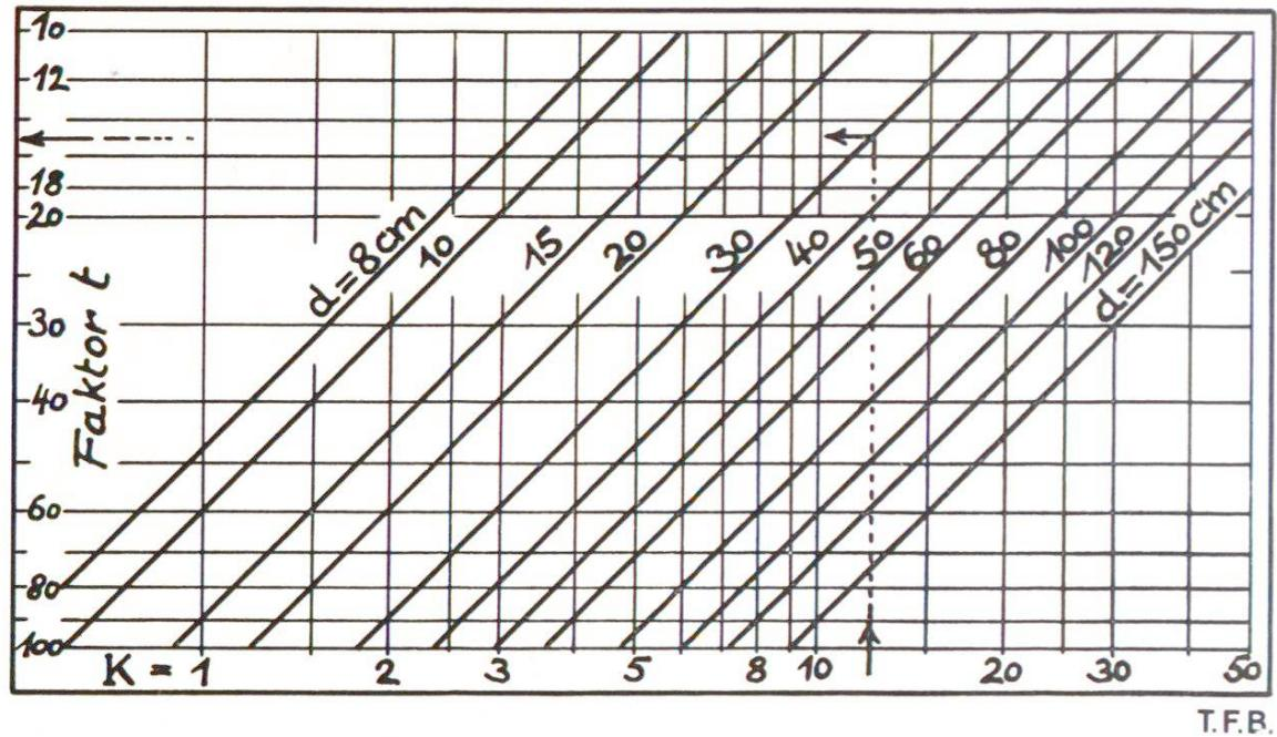
Fig. 2 Détermination du facteur de temps  $t$  à partir de  $K$  et  $d$ . Exemple dessiné:  $K = 12$  et  $d = 30$  donnent un facteur  $t = 15$ .
