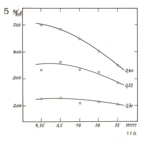
Fig. 3 Influence du grain maximum sur la résistance de bétons ayant des facteurs eau/ciment de 0,40, 0,55, et 0,70. Moyennes des bétons des trois consistances.
