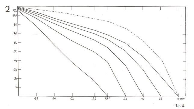
Fig. 1 Courbes granulométriques des cinq mélanges. En ordonnée le pourcentage en poids des grains de diamètres plus grands que ceux qui sont donnés en abscisses. En traitillé, la courbe idéale du LFEM pour un grain maximum de 75 mm.
