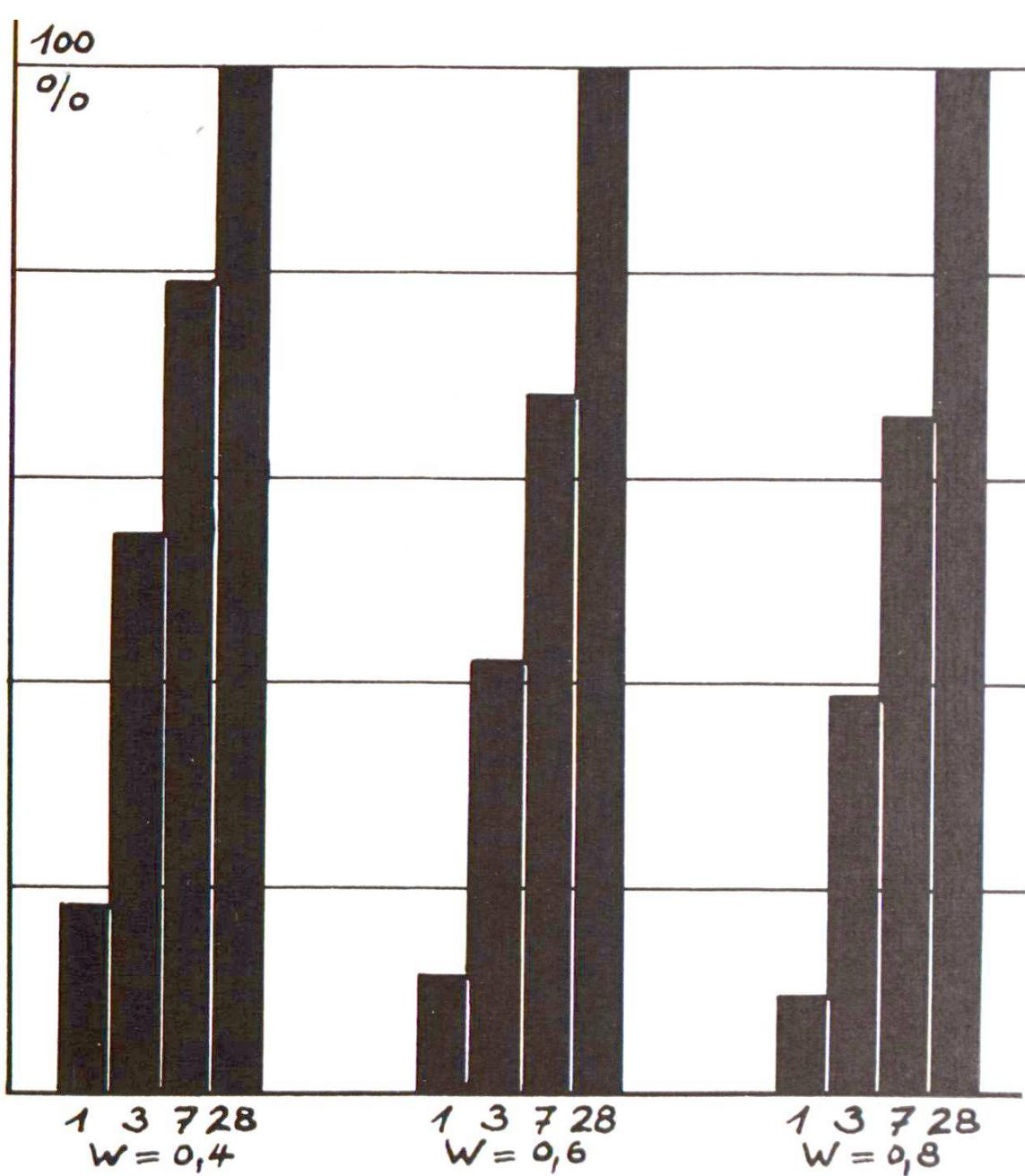
Fig. 2 Les résultats de la figure 1 exprimés en pour-cent des résistances à 28 jours.
