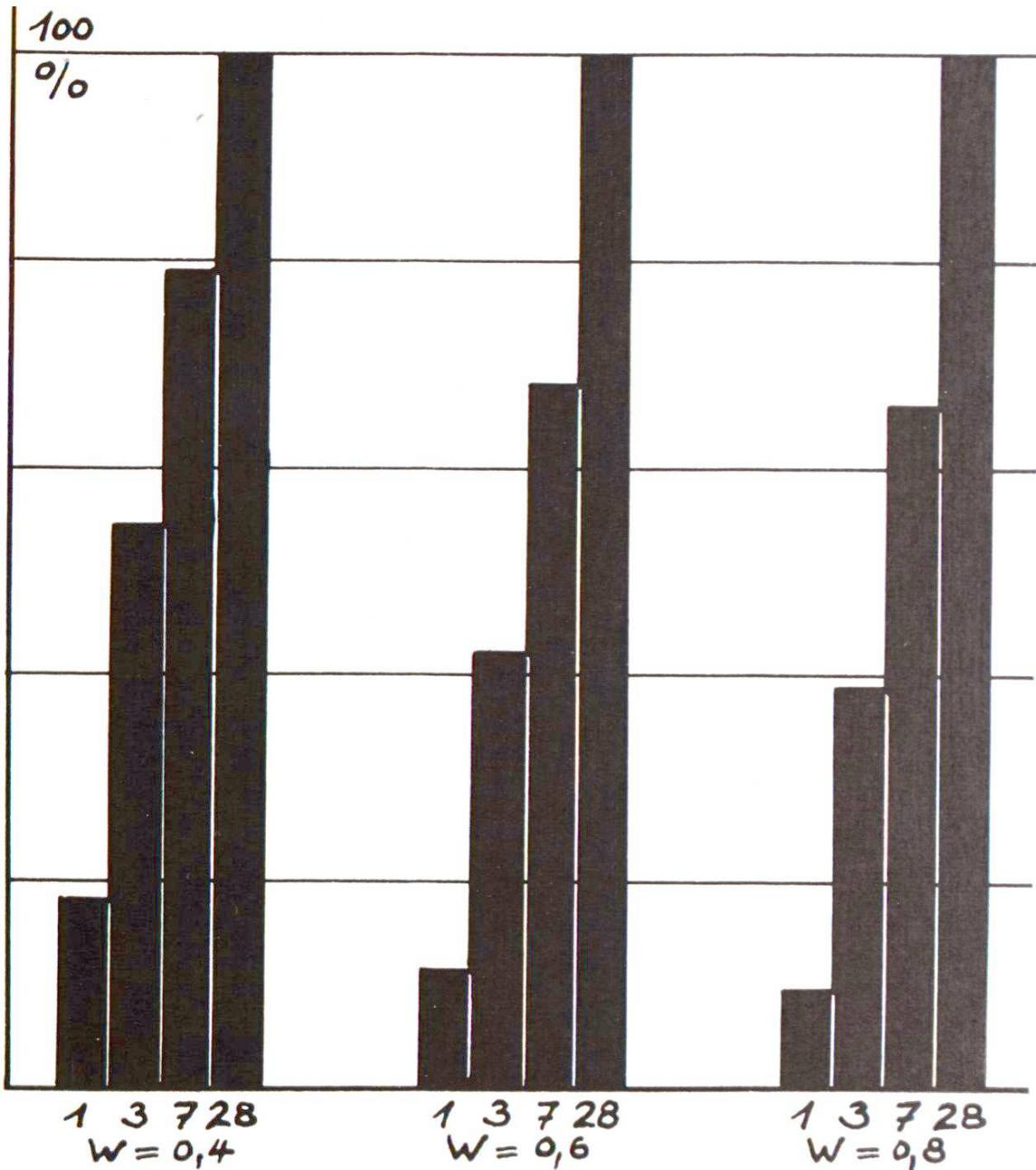
Fig. 2 Les résultats de la figure 1 exprimés en pour-cent des résistances à 28 jours.
