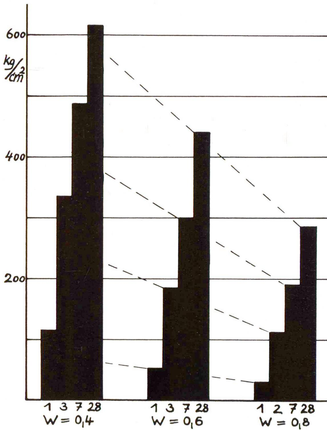
Fig. 1 Résistances à la compression sur cubes à 1, 3, 7 et 28 jours, de bétons ayant des facteurs eau/ciment de 0,4, 0,6 et 0,8. Moyennes des résultats obtenus avec trois ciments différents (selon A. Meyer).
