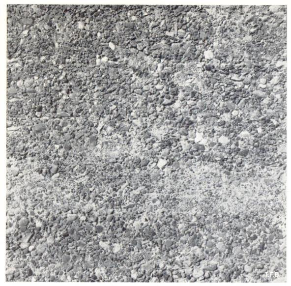
Fig. 2 Béton lavé. Gravier rond ordinaire de 30 mm. Légère ségrégation par endroits.
